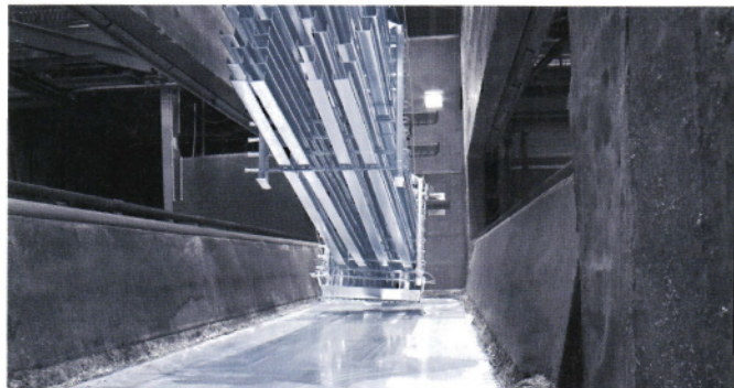
Veredelung der Stahlelemente © The Coatinc Company Holding GmbH
