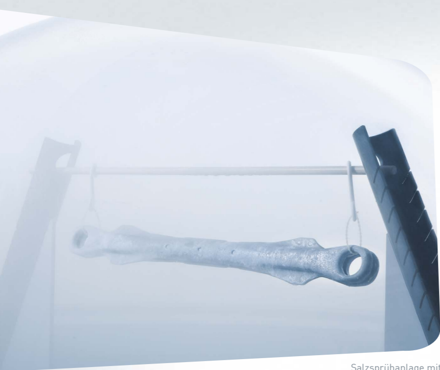
Salzsprühanlage mit Prüfling
