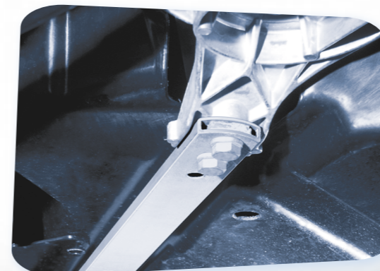
Unterbodenansicht BMW X3: hochtemperaturverzinkte Zugstrebe
