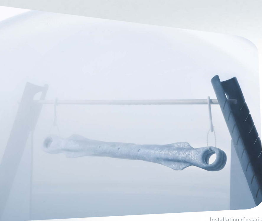
Installation d'essai au brouillard salin avec échantillon
