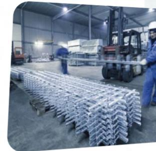
Nous proposons des châssis de transport pour l'expédition de la marchandise du client ainsi que des équipements de galvanisation qui réduisent le plus possible la surface d'appui des pièces à usiner lors du processus d'immersion. L'acier en barres est emballé avec des rubans d'acier pour que le client puisse décharger la marchandise avec un dispositif de levage magnétique.
