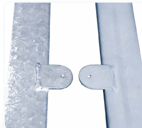
Thermisch verzinkt voorwerp met dichtgeslibd gat
