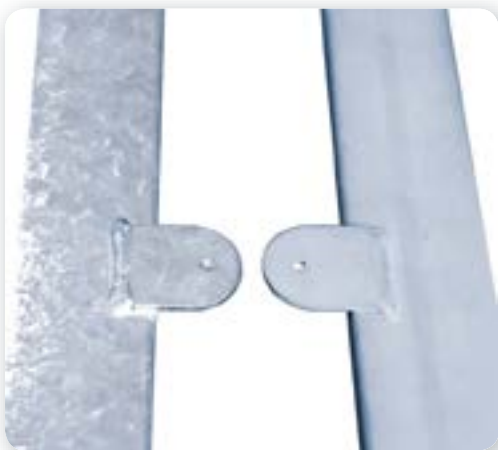
Thermisch verzinkt voorwerp met dichtgeslibd gat
