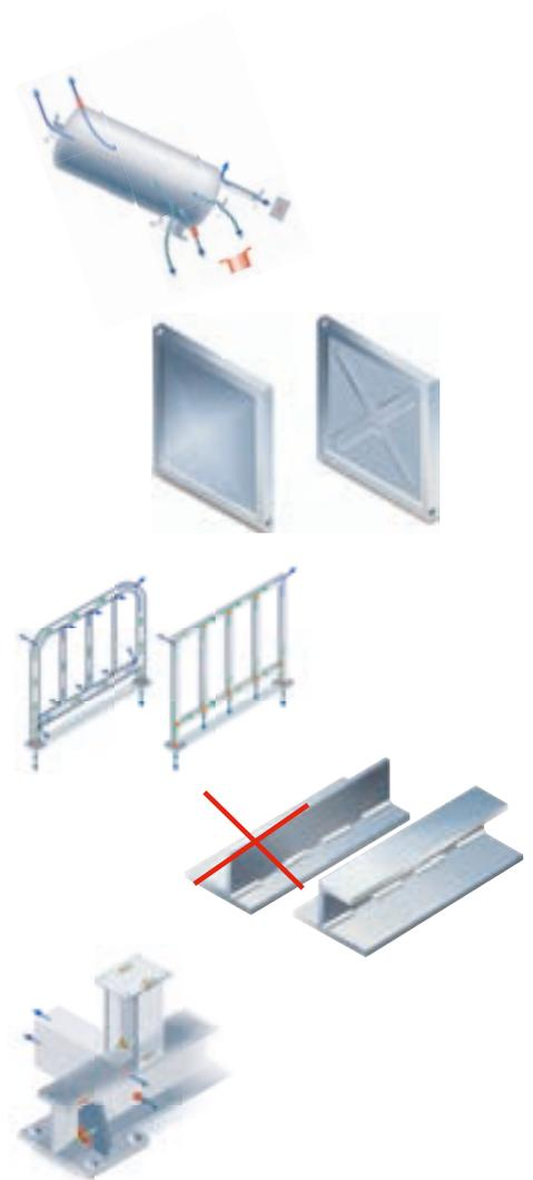
Die Mindestgrößen in der unten stehenden Tabelle gelten für mittelgroße Konstruktionen bis zu einer Länge von ca. 6 m. Bei langen Profilen sind die Größe bzw. die Anzahl der Löcher zu erhöhen. Ohne Öffnungen ist keine Feuerverzinkung von Hohlkonstruktionen wegen Explosionsgefahr möglich. Die Anordnung und die Größe der Öffnungen beeinflussen die Qualität der Feuerverzinkung.
