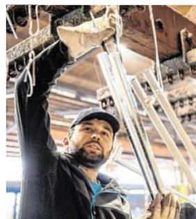
**UNTEN:** Mitarbeiter befestigen ein zu verzinkendes Teil mit Hilfe von Metalldrähten an einem vertikal und horizontal beweglichen Riesenträger.
