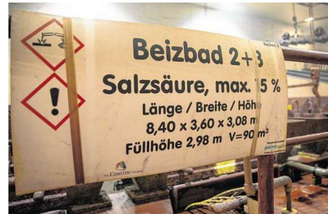
RECHTS: Bevor es ins Zinkbad geht, werden die Metallteile in Becken mit einer Salzsäurelösung getaucht.
