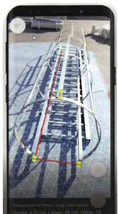
Bild 2 Die Abbildung zeigt den Bauteil-Vermessungsvorgang der Coatinc-App.
