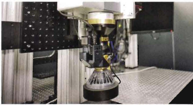
Integriertes Laserstrahlformungssystem mit „Excelliscan“-Scankopf. © Scanlab
