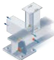
Les dimensions minimales indiquées dans le tableau ci-dessous s'appliquent à des constructions de taille intermédiaire, d'une longueur maximale de 6 mètres environ. Pour les profils longs, il convient d'augmenter la dimension et/ou le nombre de perçages. Sans ouvertures, aucune galvanisation à chaud de constructions à espaces creux n'est possible en raison du risque d'explosion. La disposition et la dimension des ouvertures influent sur la qualité de la galvanisation à chaud.
